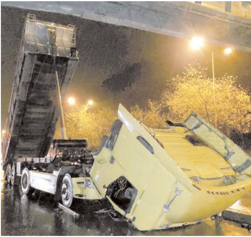
Sürücü damperin açıldığını fark edemeyince damper yaya üst geçidine çarptı.
