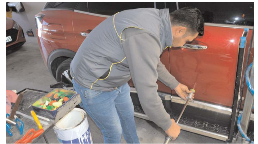
Firmada boyasız kaporta göçük düzeltme yapılıyor.
