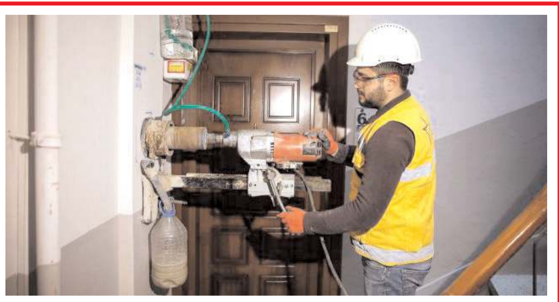
Binalardan karot örnekleri alınıyor.
