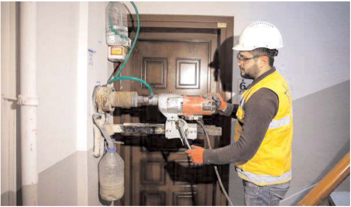
Binalardan karot örnekleri alınıyor.
