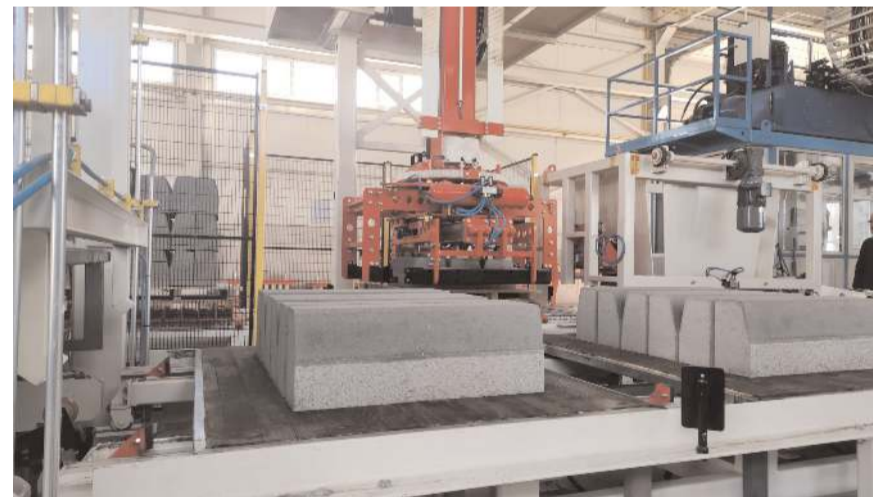
Tesiste beton bordür üretimi de yapılıyor.
