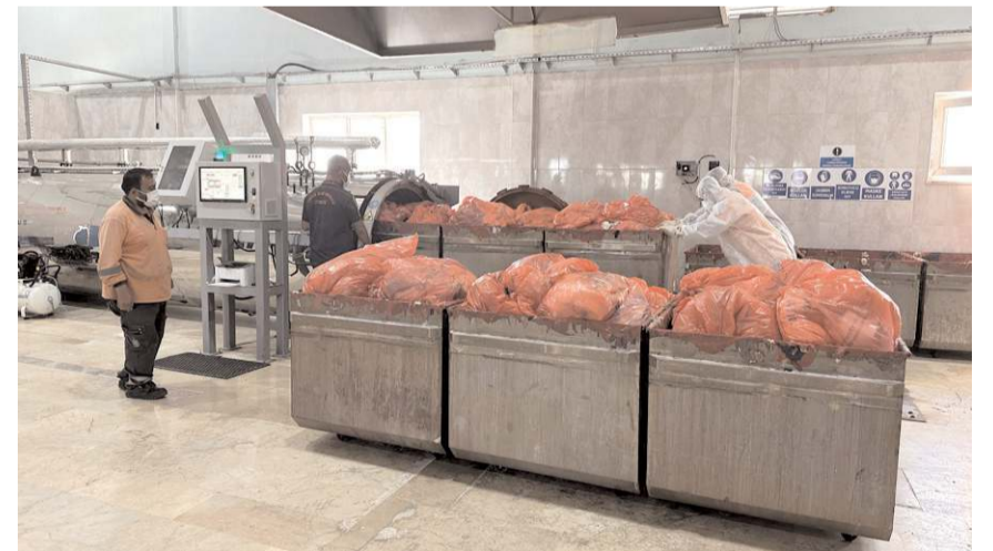
Tıbbi atıklar, sterilizasyon cihazında 138 derece sıcaklık ve 3 bar basınç altında sterilize ediliyor.
