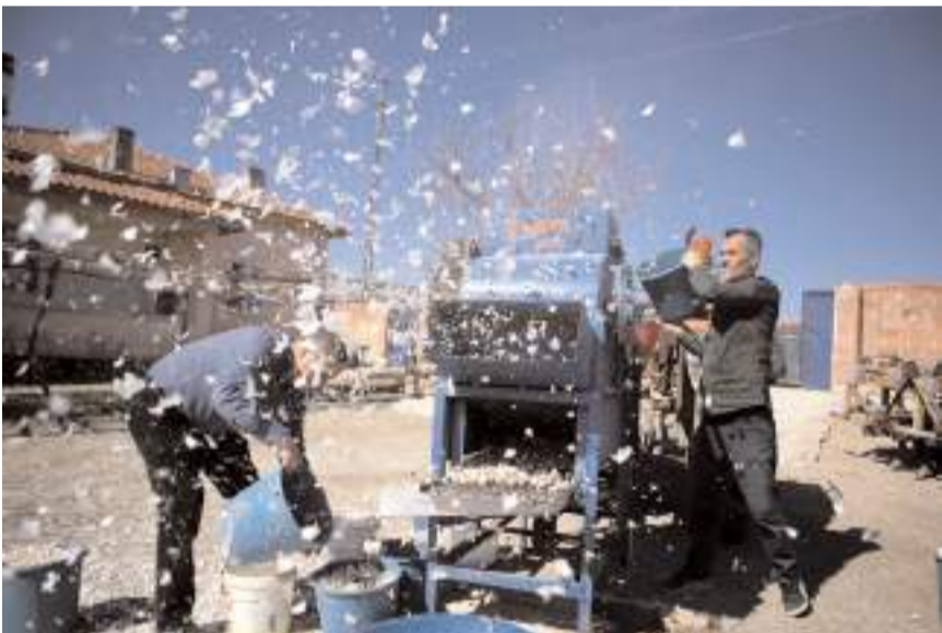
Normalde 3-4 kişinin bir günde yaptığı dişleme işlemini makine 10 dakikada yapıyor.
