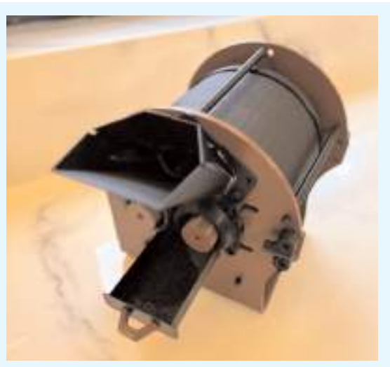
Makine kuru gıdaların karşılıklı iki merdane arasında ezilmesi prensibiyle çalışıyor.
