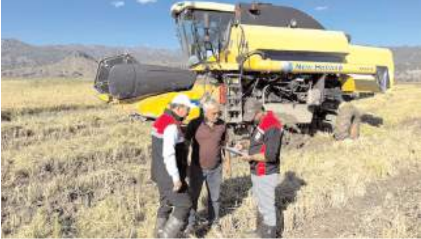
Yapılan kontrollerde, biçerdöverlerin dane kayıp oranları, biçim yüksekliği, makine ayarları, hasat hızı ve çalışma koşulları yerinde incelendi.
